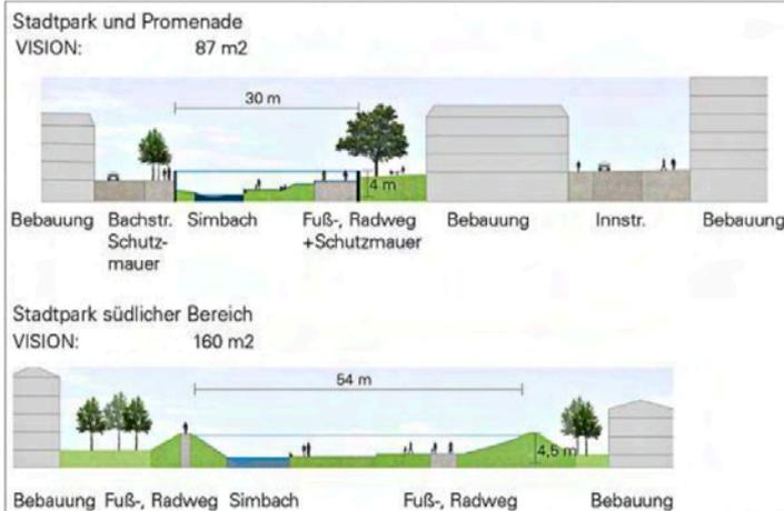
**Die beiden Querschnitte** zeigen, wie viel Raum man innerhalb des Hochwasserschutzes gewinnen könnte. Oben sieht man den Bereich zwischen Bürgerhaus und Heimatmuseum mit 30 Metern Breite und vier Metern Höhe. Verbauter Raum wären hier im Querschnitt 87 m<sup>2</sup>, jetzt sind es gerade mal 30 m<sup>2</sup>. Der Schnitt unten südlich der Kreuzberger Weg-Brücke könnte sogar 160 m<sup>2</sup> betragen, im Moment hat der Simbach hier nur 28 m<sup>2</sup> Raum.
