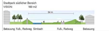
Die beiden Querschnitte zeigen, wie viel Raum man innerhalb des Hochwasserschutzes gewinnen könnte. Oben sieht man den Bereich zwischen Bürgerhaus und Heimatmuseum mit 30 Metern Breite und vier Metern Höhe. Verbauter Raum wären hier im Querschnitt 87 m<sup>2</sup>, jetzt sind es gerade mal 30 m<sup>2</sup>. Der Schnitt unten südlich der Kreuzberger Weg-Brücke könnte sogar 160 m<sup>2</sup> betragen, im Moment hat der Simbach hier nur 28 m<sup>2</sup> Raum.
